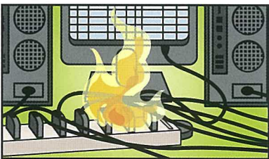
● タコ足配線 ● サーバルーム
